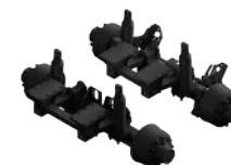
30 tonowy tandem z zawieszeniem hydraulicznym; oś skrętna kierowana
